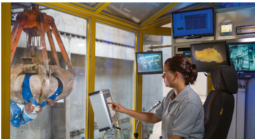
Abfallsortierung mit einem Bunkerkran. Foto: Currenta
