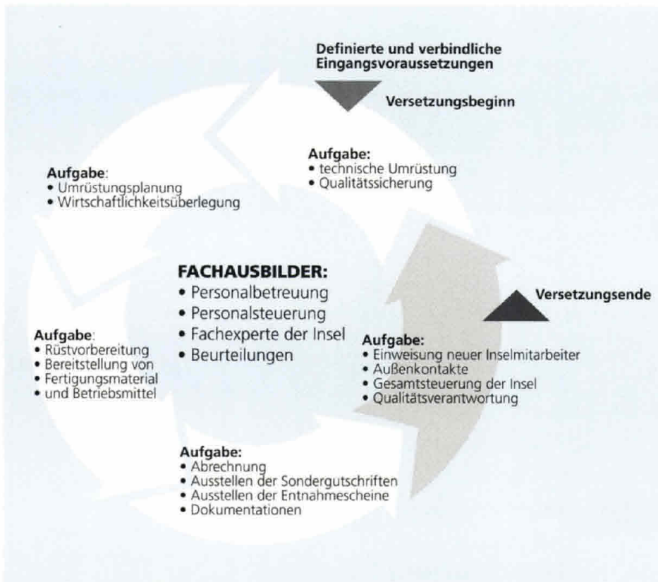
Abbildung 1: Durchlaufstationen der Lerninsel Achsenmontage
